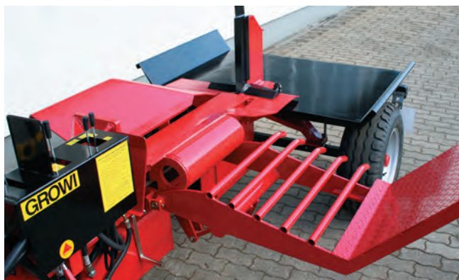
Spalttischhöhe & Stammheber sind optimal abgestimmt
