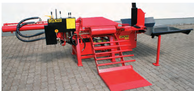
Industrierausführung: GSW 25 Elektro-Turbo mit extremer Spaltgeschwindigkeit
