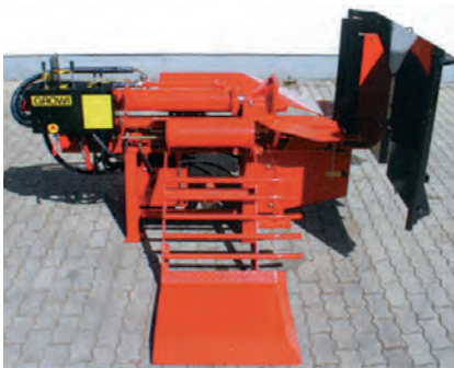
GSW 30D als Dreipunktgerät Transportstellung 2,50 m Breite
