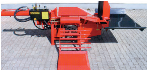
GSW 30 F Benzin TURBO 22 PS Motor. Optional kombinier- bar mit Zapfwellenantrieb
