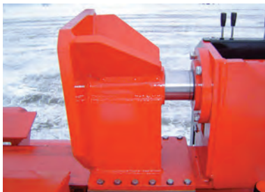
Große Druckplatte mit Messingführungen
