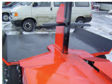
Spaltkreuz, Spalttisch und der patentierte Übergang sichtbar
