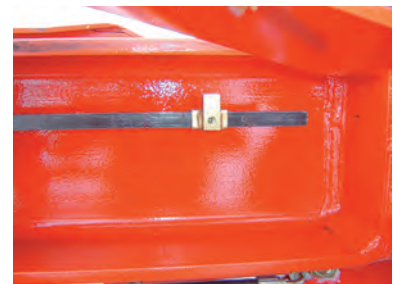
Stempelendabschaltung, Hydraulische Druckspitzen werden unmöglich. Das schont die Hydraulikpumpe
