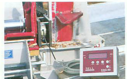
Die Spaltkraft wurde im betriebswarmen Zustand bei der empfohlenen Zapfwelldrehzahl gegen Überdruck gemessen.
