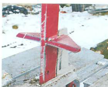
Das Spaltmesser samt Halterung verformte sich während des Testes bereits deutlich.
