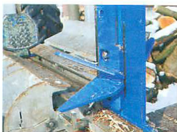
Zum Wechsel zwischen Vier- und Sechsfachmesser muss man schrauben, und es gibt keine „Park“-Position. Der Messerhalter ist sehr stabil, hat aber wenig Bodenfreiheit und einen ungeschützten Zylinder.
